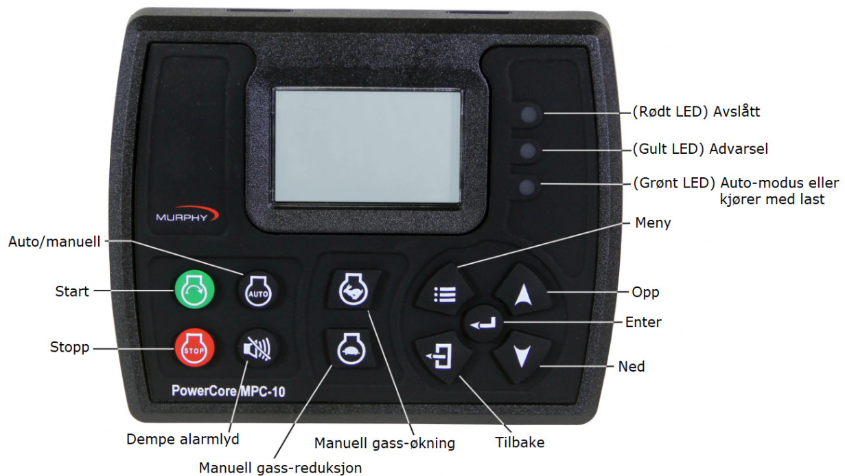
Illustrasjon 2.6: Kontrollpanel, beskrivelse av knappene
